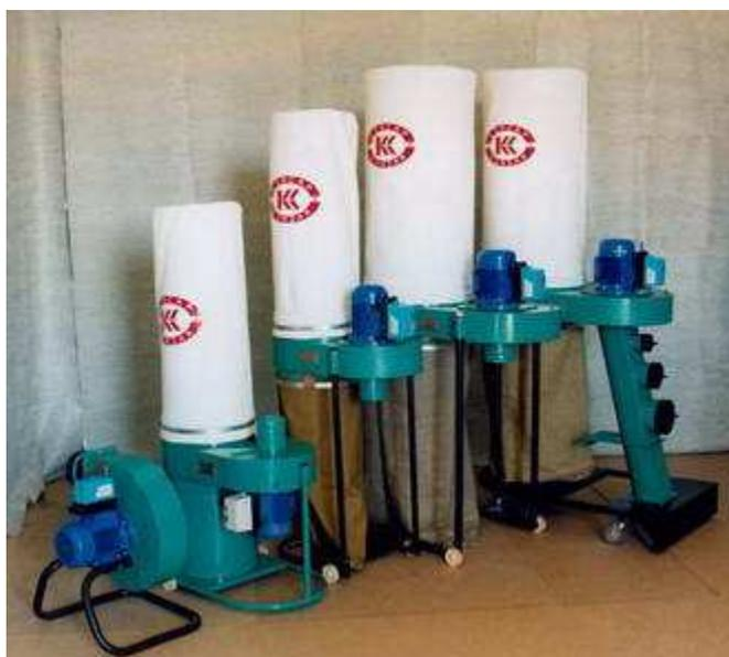
**Стружкоотсос (аспирационная установка)** – это оборудование, которое используется для удаления всевозможной мелкой деревянной, пластиковой, металлической стружки и для удаления пыли образующейся от распиловки камня и плитки, то есть стружкоотсос – это обычный промышленный пылесос. Использование стружкоотсоса позволяет отказаться от обычной вытяжной вентиляции. Размер стружки и пыли, удаленной в процессе работы стружкоотсосом составляет примерно от 5 мкм и более.
